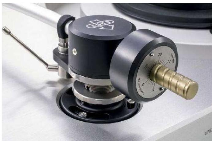
Der Klassiker neu aufgelegt: Edelstahl für Basis und Schaft, Aluminium für alle beweglichen Teile, Neusilber für abriebgefährdete Parteien. Die Antiskating-Vorrichtung arbeitet nun berührungslos magnetisch.
